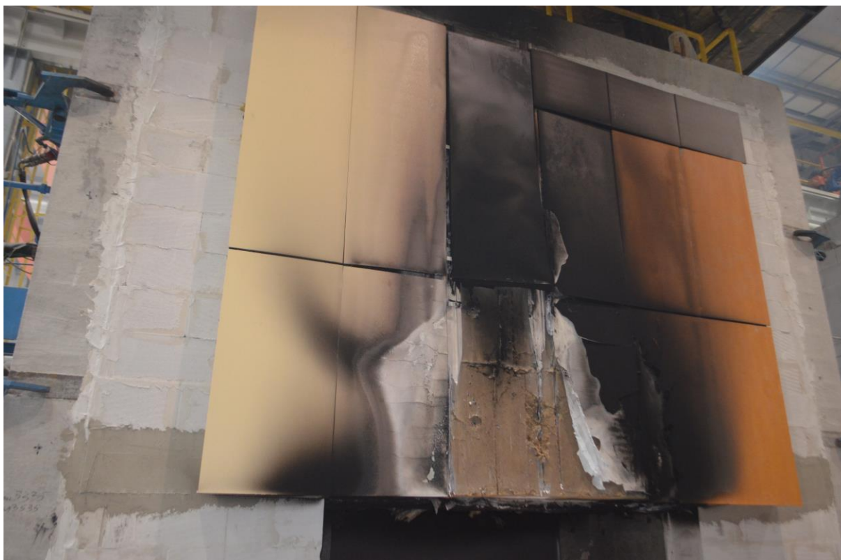
Rys. 9. Widok elementu próbnego po badaniu
