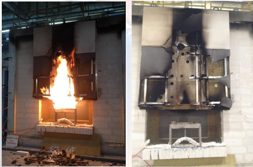
FOTO 1 i 2. TESTY DOTYCZĄCE ODPADANIA ELEWACJI PODCZAS POŻARU.
