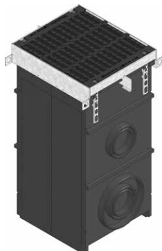
studzienka z tworzywa z rusztem żeliwnym, szczelinowym, kl. E 600
