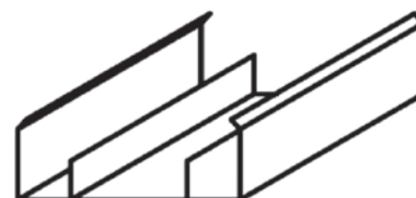
Osłona podstawy (bez otworu) Długość: 60 mm Ilość 500 szt.
