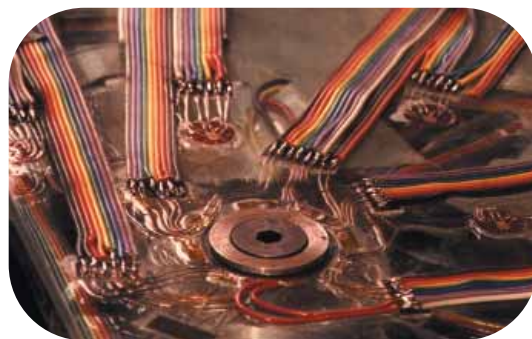
Badanie określające naprężenia wokół otworu.
