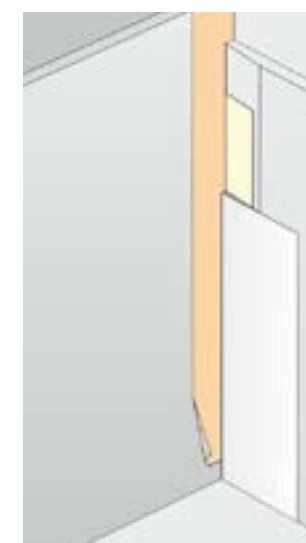
Narożne połączenie płyt gipsowo-kartonowych z powierzchnią tynkowaną: przy połączeniu z tynkiem lub betonem, przed zaszpachlowaniem, należy nakleić taśmę samoprzylepną RIGIPS PRO do połączeń ślizgowych. Po szpachlowaniu należy usunąć wystającą część taśmy.
