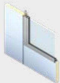
Detal połączenia z oknem
