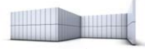
6. Instalacja pionowa z fugą poziomą
