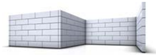
2. Poziomy z przesunięciem - symetryczny
